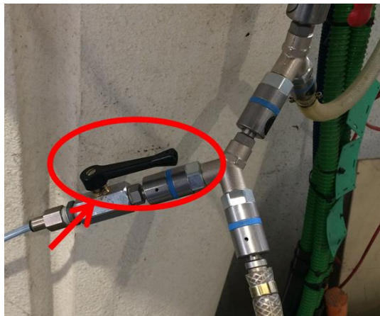
3 – Mettre en route l'air comprimé (la vanne doit se trouver dans le prolongement du flexible, le bruit de l'air est audible au niveau de la tête laser)
