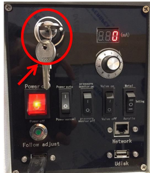
4 – Allumer la machine en tournant la clef de mise en route. NE TOUCHER AUCUN AUTRE ELEMENT DU PANNEAU DE CONTROLE
